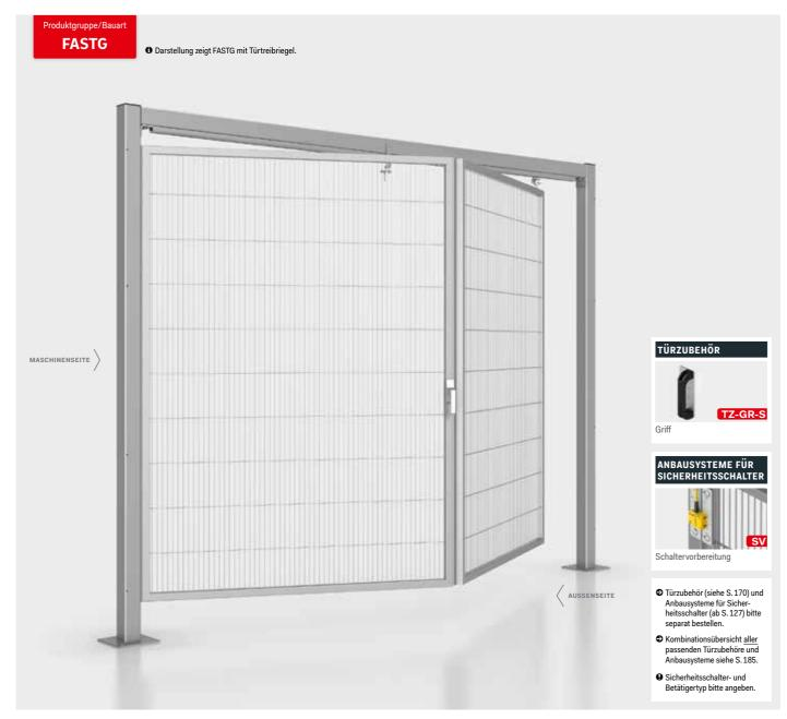
Die Faltschiebetüren haben nur einen geringen Platzbedarf im geöffneten Zustand. Die Türpfosten dieser Tür bestehen aus einem stabilen Stahlprofil mit angeschweißter Vierlochbodenplatte. Standardmäßig sind beide Türpfosten für eine Eck- und Durchgangssituation vorbereitet. Durch langlebige Führungsschienen und Laufrollen haben die Faltschiebetüren sehr genaue und präzise Flügelverfahrwege.
