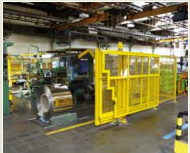
Abb. B: Maschine nach dem Umbau der Schutzeinrichtung, Tür in Position offen/geschwenkt
